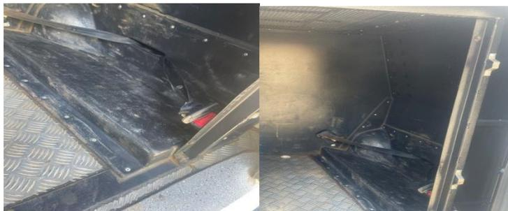
f10) O interior do compartimento traseiro deverá sofrer as adaptações necessárias a fim de não permitir que seus eventuais ocupantes tenham acesso a qualquer um dos equipamentos obrigatórios (ferramentas, estepe, etc.) ou outras partes do veículo existentes nesse compartimento, que possam colocar em risco a integridade física dos policiais ou ainda de qualquer cidadão;
