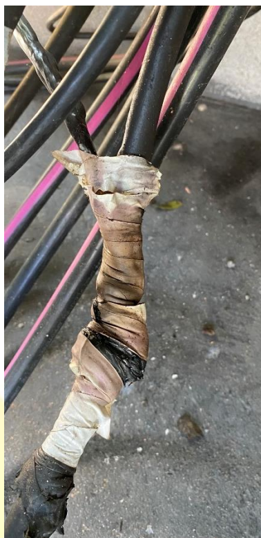
Foto 47 – Condutor fase com sinais de derretimento
